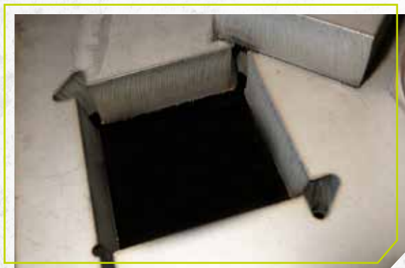
Découpe de 60 mm avec WMS (en utilisant N 2 comme gaz plasmagène et l'eau comme élément secondaire) à 800 A
